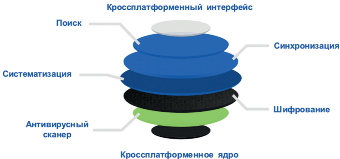
Рис. 1. Общая схема логических слоев криптоконтейнера Fig. 1. General scheme of logical layers of the crypto container
